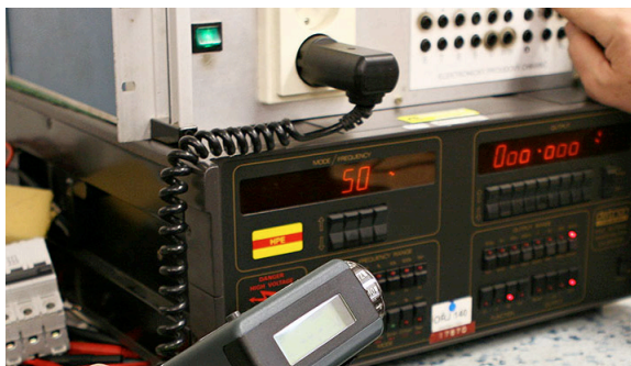
Obr. 9 Kalibrace měřícího přístroje
