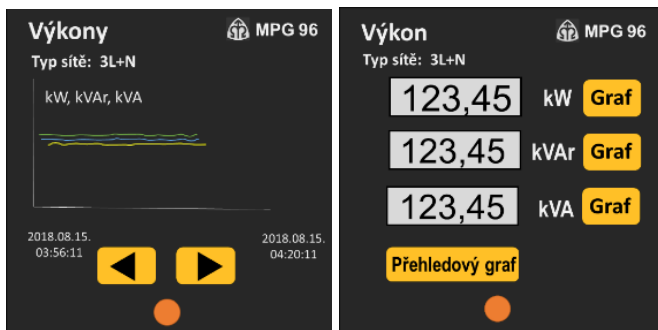
Obr. 2 Digitální panelový přístroj MPG 96 a zobrazení panelu s grafem a hodnotami
